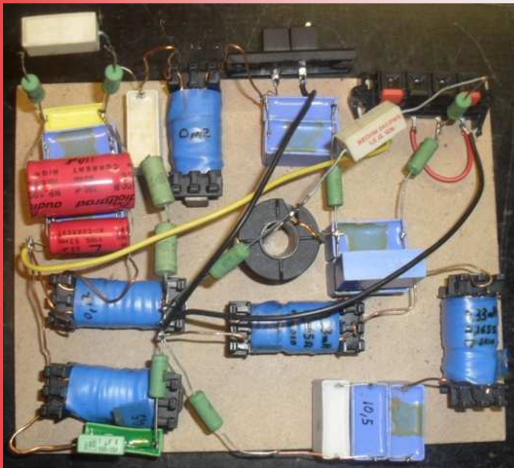
Prototipo del filtro crossover montato in aria
